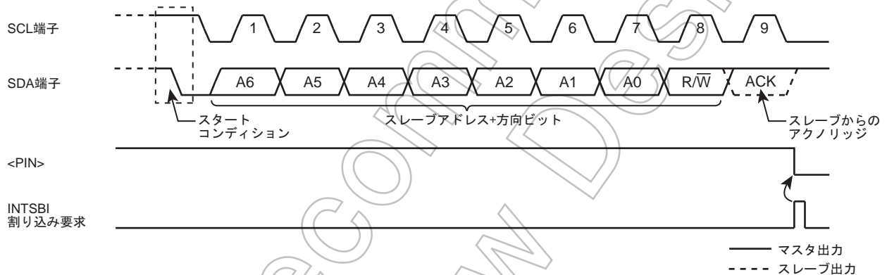
図 9-9 スタートコンディションとスレーブアドレスの発生
