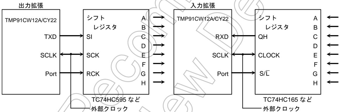
図 3.10.18 SCLK 入力モード接続例
