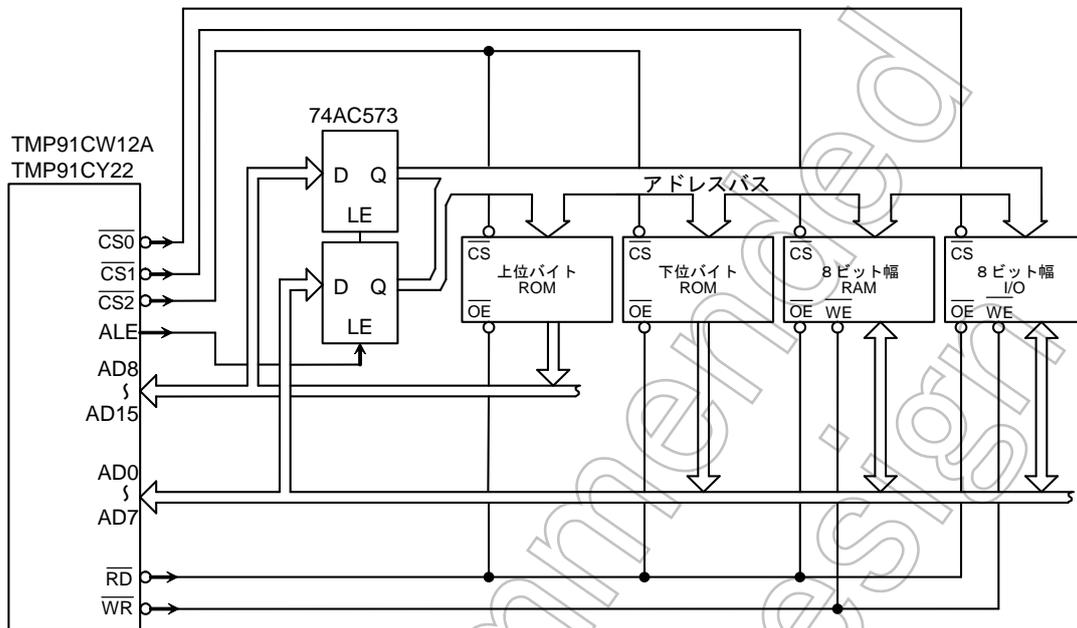
図 3.7.6 外部メモリ接続例 (ROM = 16 ビット幅、RAM & I/O = 8 ビット幅)
