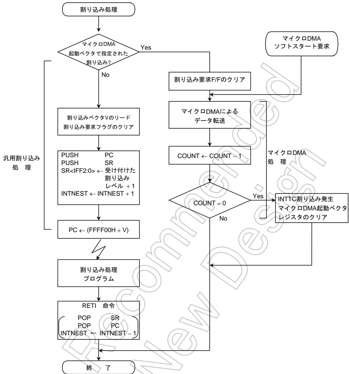
図 3.5.1 割り込み処理全体のフロー
