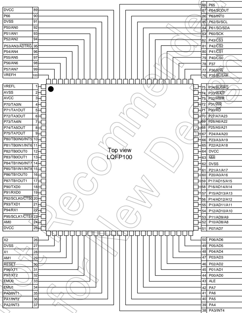
図 2.1.1 ピン配置図 (100 ピン LQFP)
