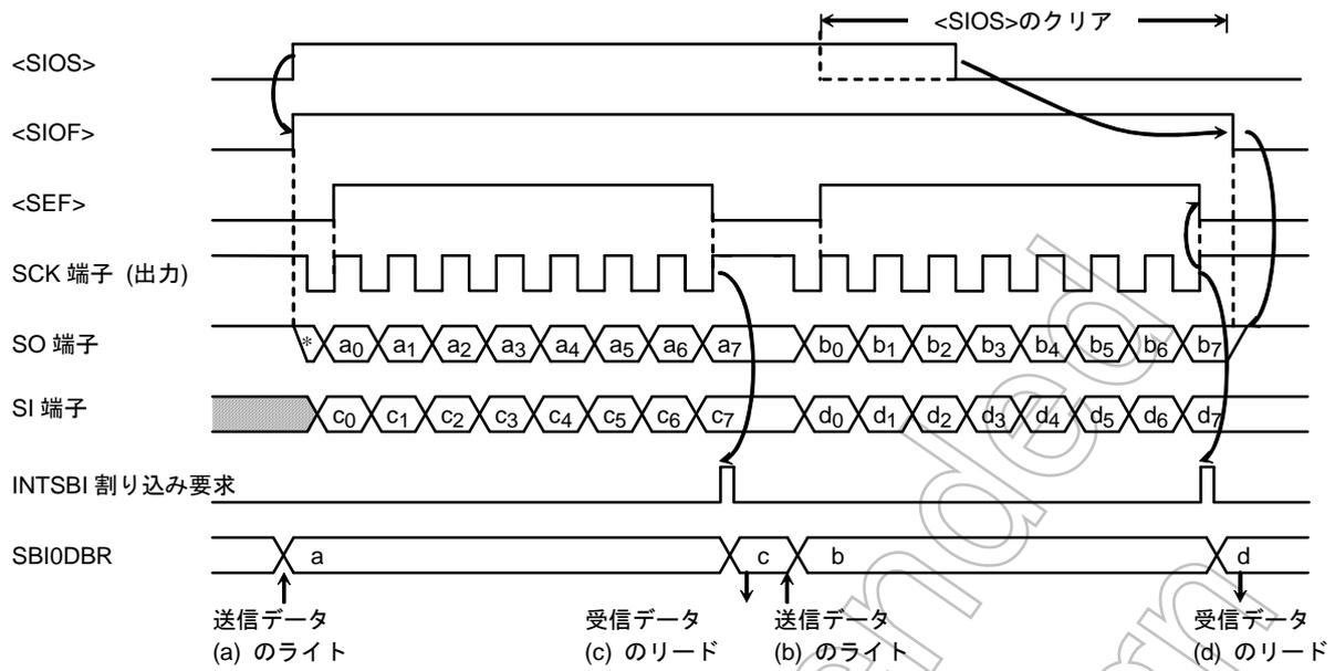
図 3.11.28 送受信モード (例: 内部クロック)
