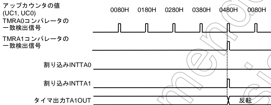
図 3.8.16 16 ビットタイマモードによるタイマ出力
