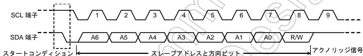
図 3.11.9 スタートコンディションの発生とスレーブアドレスの発生
