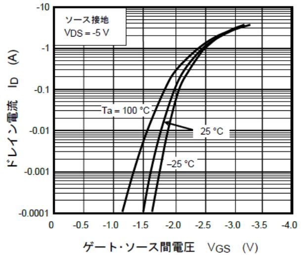
図 7.2  $I_D - V_{GS}$
