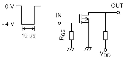
図 5.3.1 スイッチング時間の測定回路
