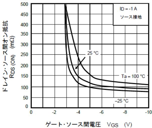
図 7.3  $R_{DS(ON)} - V_{GS}$
