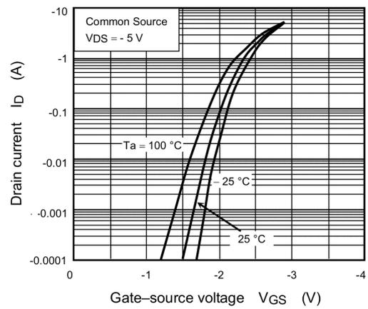
Fig. 7.2  $I_D - V_{GS}$
