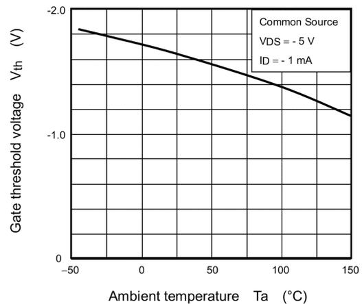
Fig. 7.6  $V_{th} - T_a$
