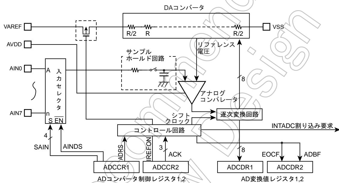
図 11-1 8 ビット AD コンバータ
