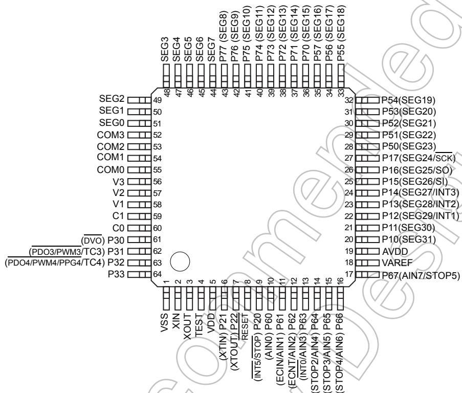
図 1-1 ピン配置図
