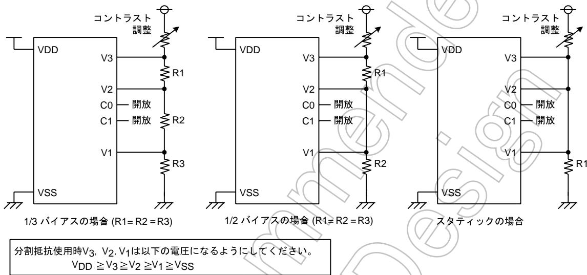
図 13-4 外部分割抵抗使用時の LCD 電源接続例 (LCDR<BRES>= “0” )
