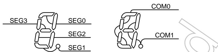
図 13-7 COM, SEG 端子接続例
