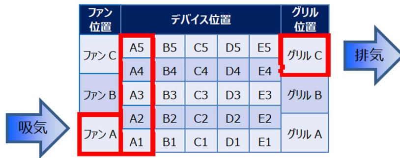
図 4. モデル 1 で使用される MOSFET、ファン、グリルの構成
