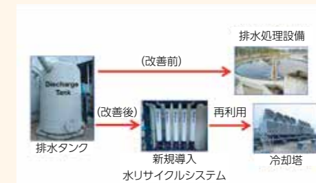
工程で使用し排水していた水について、リサイクルのシステムを導入し、冷却塔の循環水として再利用
