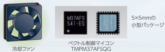
冷却ファン ベクトル制御マイコン TMPM37AFSQG 5×5mmの小型パッケージ
