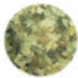
(従来の研磨材) 不飽和ポリエステル サイズ: 250~425μm
