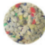
(改善後の研磨材) メラミン樹脂 サイズ: 180~250μm
