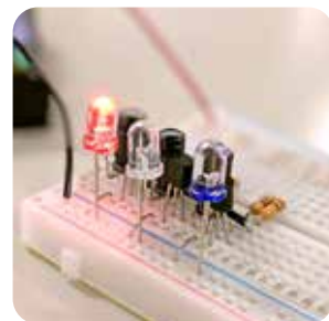
完成した半導体とLEDの信号機
