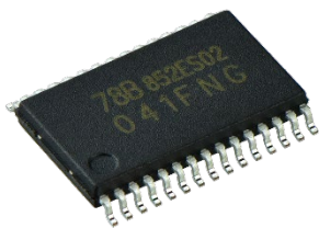
SSOP30パッケージ (10.2 mm x 7.6 mm x 1.6 mm)
