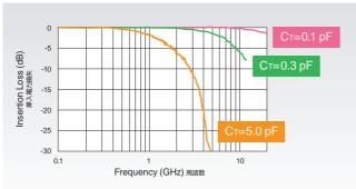
Diodes with lower total capacitance exhibit lower power loss. 端子間容量が小さいほど、電力損失が小さくなります。
