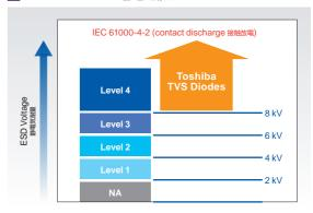
With ESD immunity of higher than 8 kV, Toshiba's TVS diodes meet the Level 4 requirements of IEC 61000-4-2 (contact discharge). 当社製品は静電気耐量8 kV以上の実力を有しており、IEC61000-4-2 (接触放電) 規格 Level 4を満たしています。
