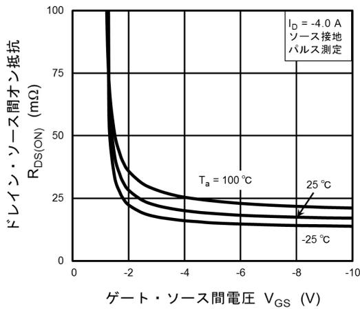
図 7.3  $R_{DS(ON)} - V_{GS}$
