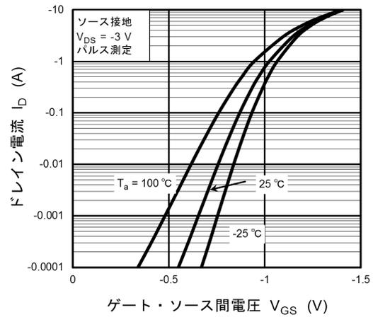
図 7.2  $I_D - V_{GS}$
