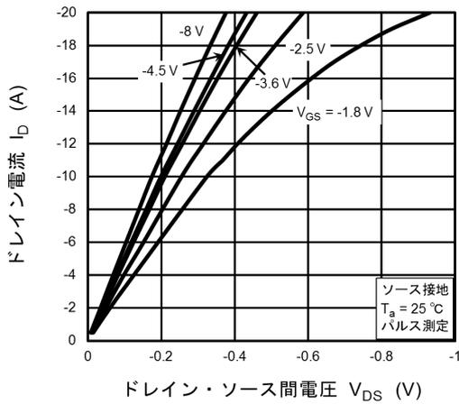
図 7.1  $I_D - V_{DS}$
