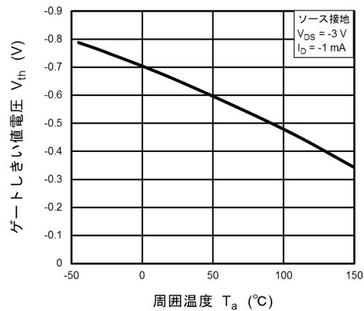
図 7.6  $V_{th} - T_a$
