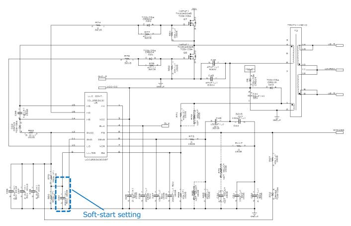
Fig. 2.17 Soft-Start Setting Circuit
